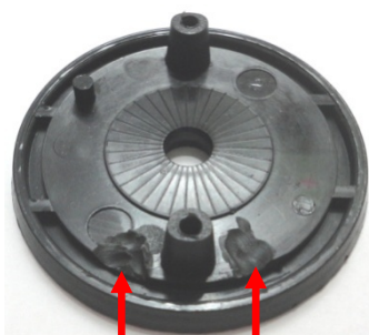
Material removido para balanceamento do disco.
